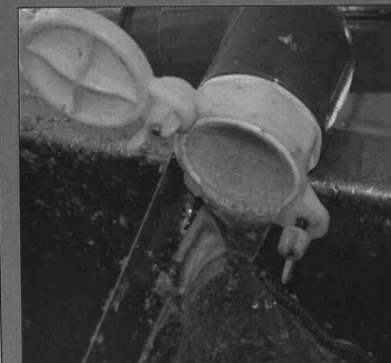
La miel cae del extractor a unas cubetas metálicas, y a través de un conducto, y tras pasar varios filtros, desciende al piso inferior, donde va depositándose en los tanques de almacenaje
